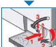
داخل درپوش و محفظه پمپ را از پر ز و اشیا، دیگر تمیز کنید (پروانه پمپ باید به راحتی بچرخد)
