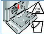
\*۲. برای مدل های بدون شلنگ تخلیه: درب پمپ را به دقت باز کنید تا پمپ شروع به سرریز شدن کند. وقتی دریچه تعمیرات نیمه پر شد، درب پمپ را ببندید و دریچه را خالی کنید تا زمانی که پمپ بطور کامل خالی شود، این کارها را تکرار کنید.
