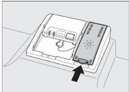
– مایع آبکشی را با احتیاط داخل مخزن بربیزید به طوریکه سطح آن از لبه مدخل ورودی تجاوز نکند.
