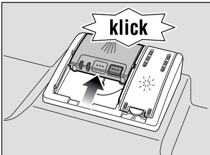
دریچه محفظه بسته به نوع برنامه انتخابی شما در زمان لازم بطور خودکار باز می شود. اگر پاک کننده بشکل مایع یا پودر باشد. داخل ماشین پخش شده و آب میشود. اگر پاک کننده بشکل قرص باشد. قرص در داخل ماشین به پائین افتاده و در آنجا آب میشود.
