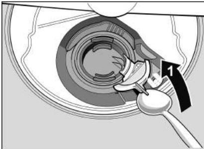
داخل پمپ را کنترل کنید و اگر چیزی در آن گیر کرده باشد، دفع کنید.
