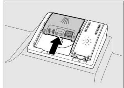
باز شدن دریچه مخزن ماده شوینده بطور اتوماتیک و بسته به نوع برنامه شستشو انجام می گیرد. پودر یا مایع شوینده در داخل دستگاہ پخش و حل می شود، اما قرص به ظرف مخصوص قرص می افتد و در آن جا بندریج حل می شود.
