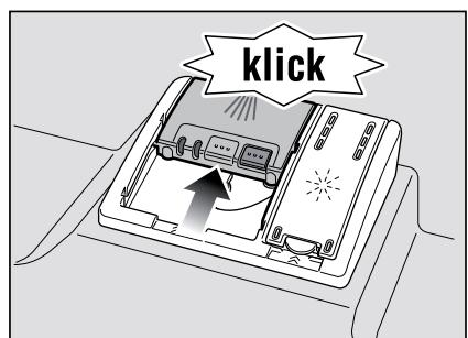
دربیچه محفظه بسته به نوع برنامه انتخابی شما در زمان لازم بطور خودکار باز می‌شود. اگر پاک کننده بشکل مایع یا پودر باشد، داخل ماشین پخش شده و آب می‌شود. اگر پاک کننده بشکل قرص باشد، قرص در داخل ماشین به پائین افتاده و در آنجا آب می‌شود.
