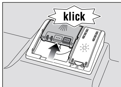
دریچه محفظه بسته به نوع برنامه انتخابی شما در زمان لازم بطور خودکار باز می شود. اگر پاک کننده بشکل مایع یا پودر باشد، داخل ماشین پخش شده و آب میشود. اگر پاک کننده بشکل قرص باشد، قرص در داخل ماشین به پائین افتاده و در آنجا آب میشود.
